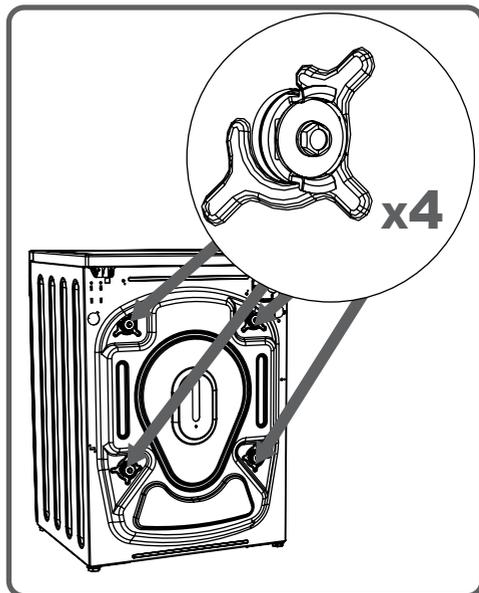
Pour cette raison, les vis de bridage transport doivent être dévissées par rotation dans le sens contraire aux aiguilles d'une montre à l'aide d'une clé appropriée.
