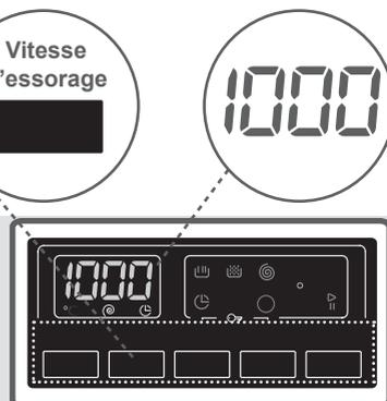
Vous pouvez progressivement réduire la vitesse de rotation en la faisant basculer entre les options (--) d'annulation de l'essorage et la rotation maximale de l'essorage du programme sélectionné en appuyant sur le bouton de réglage de la vitesse de rotation.
