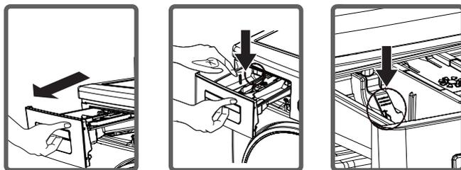
Nettoyez-le à grande eau et à l'aide d'une brosse à dents usagée. Enlevez le siphon de l'assouplissant et nettoyez soigneusement les résidus d'assouplissant. Nettoyez et remettez le siphon en place et vérifiez qu'il est bien en place
