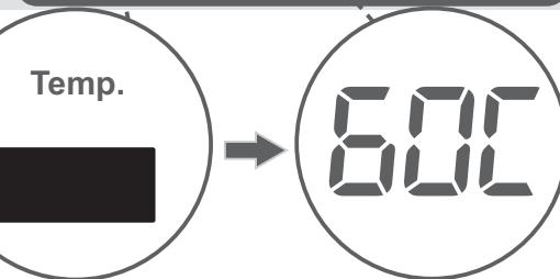
Vous pouvez progressivement diminuer la température de l'eau de lavage entre la température maximale et le lavage à froid (--) en appuyant sur le bouton de réglage de la température de l'eau de lavage.
