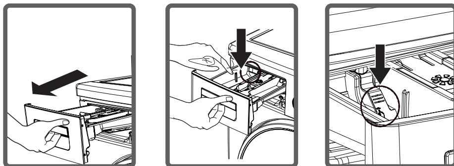
Nettoyez-le à grande d'eau et à l'aide d'une brosse à dents usagée. Enlevez le siphon de l'assouplissant et nettoyez soigneusement les résidus d'assouplissant. Nettoyez et remettez le siphon en place et vérifiez qu'il est bien en place
