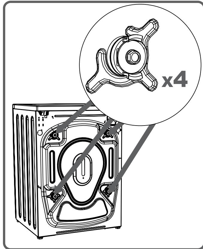
Pour cette raison, les vis de bridage transport doivent être dévissées par rotation dans le sens antihoraire à l'aide d'une clé appropriée.
