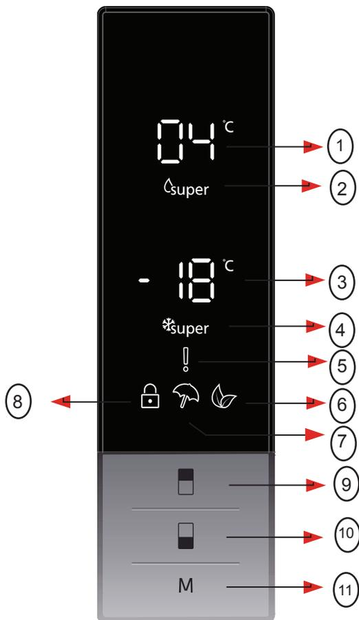
1. Écran de réglage de la température du compartiment réfrigérateur.
