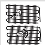
comportant les ailettes noires — l'arrière) en le tournant dans l'intervalle d'un angle de 90° comme l'illustre la figure pour éviter que le condenseur ne touche au mur.
