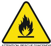
Le gaz frigorigène contenu dans le circuit de cet appareil est de l'isobutane (R600a), gaz peu polluant mais inflammable. Lors du transport et de l'installation de l'appareil, veiller à n'endommager aucune partie du circuit frigorifique N'utilisez aucun outil coupant ou pointu pour dégivrer l'appareil.
