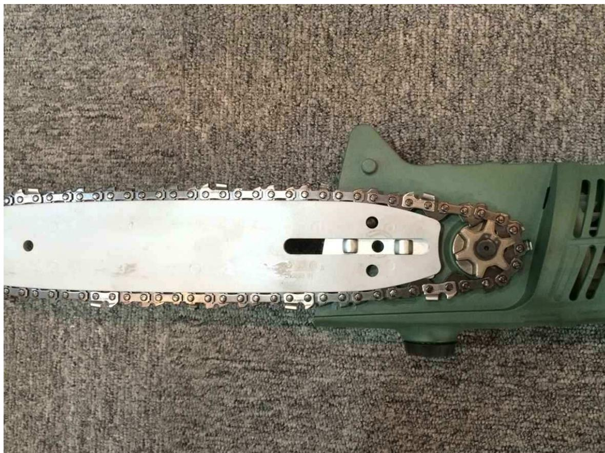
1. Tourner la vis d'ajustement dans le sens inverse des aiguilles d'une montre jusqu'au moment où le support guide-chaîne est positionné au fond de la plaque.
