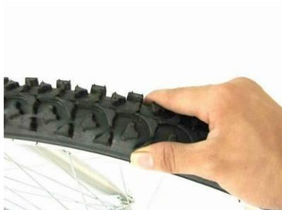
Contrôlez l'usure et la pression de gonflage des pneus. La bonne pression de gonflage est indiquée sur l'extérieur du pneumatique. **Pour indication : 14,5 PSI = 1 BAR et 1 BAR = 1Kg/cm<sup>2</sup>.** Remplacez les pneus et les chambres à air lorsqu'ils sont usés ou défectueux
