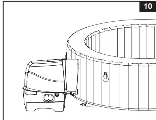
3. Insérez le boîtier de filtre sur la buse d'aspiration de la cuve du spa (position inférieure) (**voir dessin 11**). Gonflez le Spa avant d'installer les raccords de la filtration.
