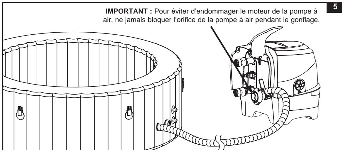
**IMPORTANT** : Pour éviter d'endommager le moteur de la pompe à air, ne jamais bloquer l'orifice de la pompe à air pendant le gonflage.
