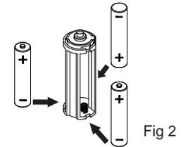
3. Réinstaller le compartiment à piles (2) dans la lumière d'ambiance spa en respectant l'orientation prévue (voir Fig 3).
