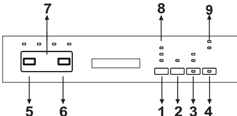
En appuyant sur le bouton Marche/Arrêt (4), la machine se met sous tension. Le voyant Marche/Arrêt reste allumé aussi longtemps que la machine est en marche.
